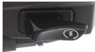
Imagen 3. Interruptor de arranque eléctrico.
