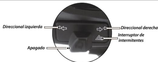
Imagen 7. Interruptor de direccionales e intermitentes.
