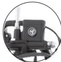
Imagen 23. Nivel del líquido de freno delantero.
