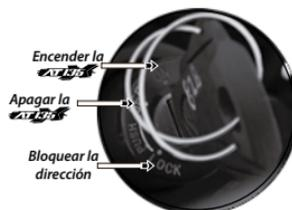
Imagen 9. Interruptor de encendido y bloqueo.
