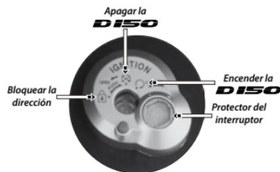
Imagen 6. Interruptor de encendido y bloqueo.
