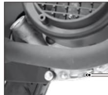
Imagen 14. Ubicación del tornillo de drenado.
