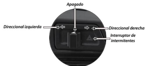
Imagen 5. Interruptor de direccionales e intermitentes.
