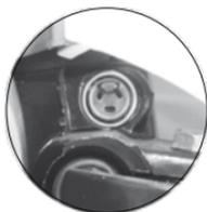
Imagen 20. Nivel del líquido del freno delantero.
