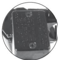
Imagen 21. Completar el nivel del líquido del freno delantero.
