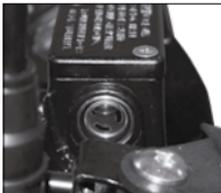
Imagen 21. Nivel del líquido del freno delantero.
