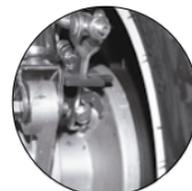
Imagen 20. Desgaste del freno trasero.
