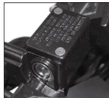
Imagen 22. Completar el nivel del líquido del freno delantero.
