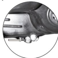
Imagen 16. Ubicación del tornillo de drenado.
