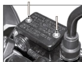
Imagen 25. Completar el nivel del líquido de frenos.
