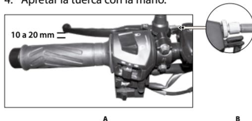
Imagen 20. Ajuste de la palanca del embrague.
