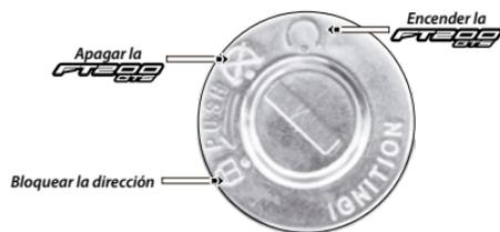
Imagen 8. Interruptor de encendido y bloqueo.
