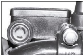
Imagen 24. Nivel del líquido del freno delantero.
