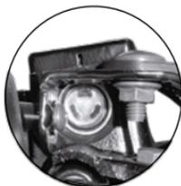
Imagen 21. Nivel del líquido del freno delantero.
