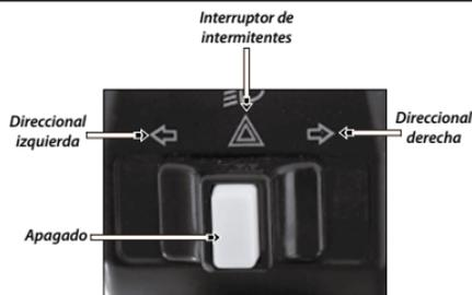
Imagen 6. Interruptor de direccionales e intermitentes.
