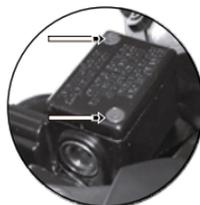
Imagen 22. Completar el nivel del líquido del freno delantero.
