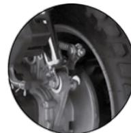
Imagen 20. Desgaste del freno trasero.
