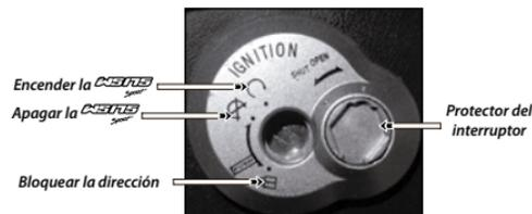
Imagen 7. Interruptor de encendido y bloqueo.
